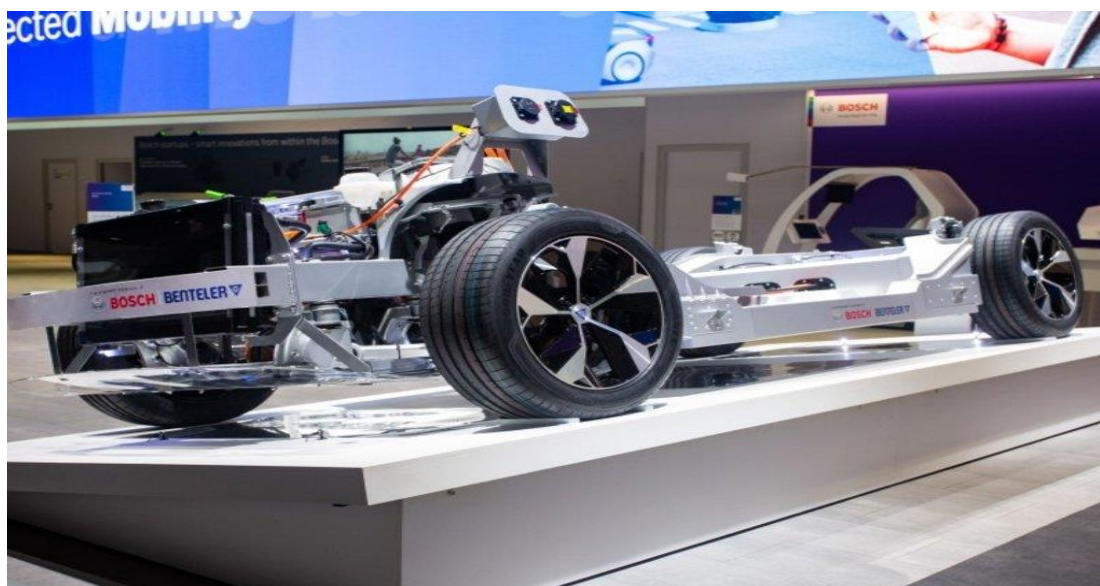
Rysunek 22. Platforma „skateboard” zaprojektowana przez Bosch/Benteler
